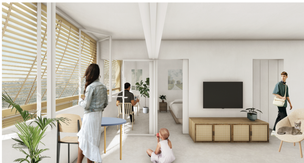
VERANO La galería actúa de umbráculo accionable creando una ventilación cruzada con la fachada perpendicular.
