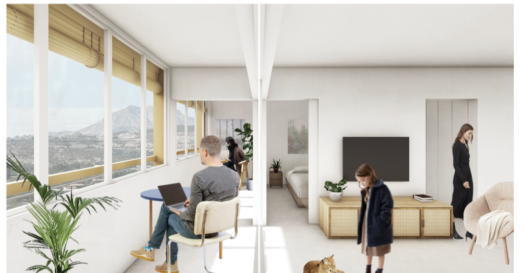
INVIERNO La galería actúa como un invernadero precalentando pasivamente el aire, actuando la masa del suelo y paredes como acumulador.
