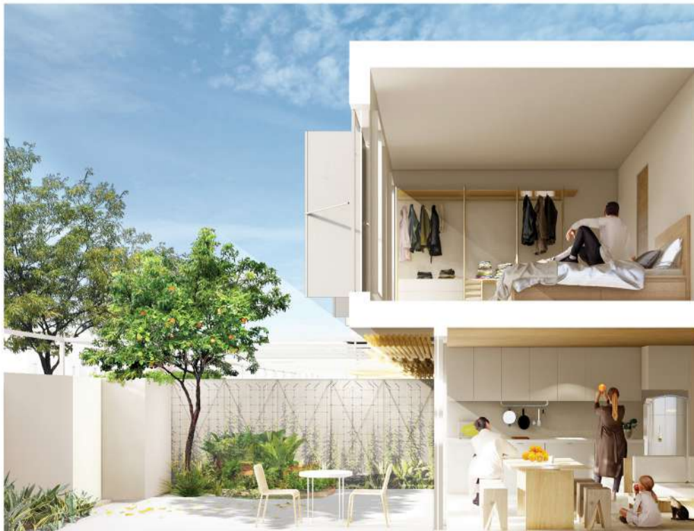
Invierno: La galería actúa como un invernadero precalentando pasivamente el aire, actuando la masa del suelo y paredes como acumulador.
