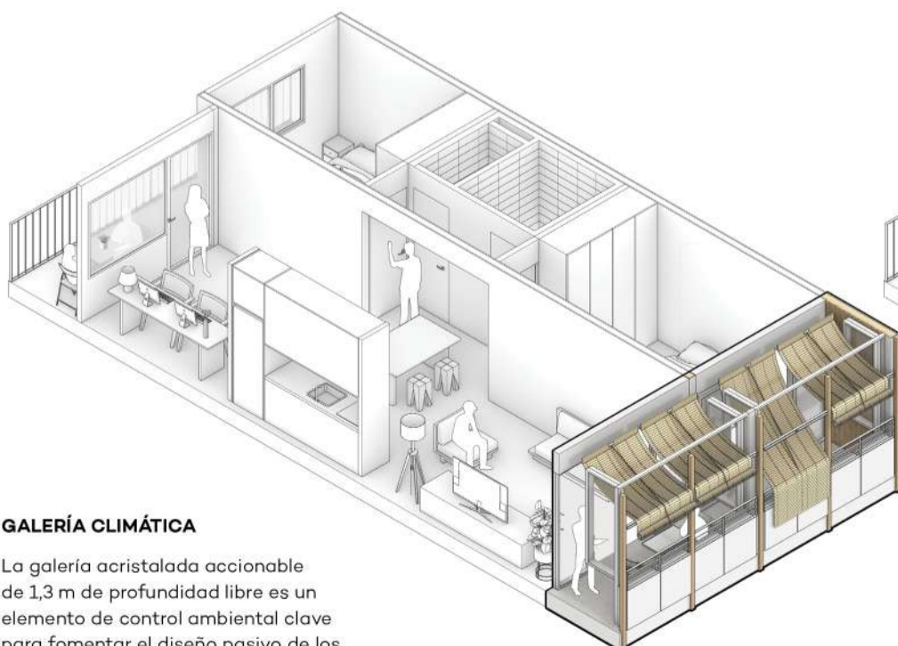
Verano: La galería actúa de umbráculo accionable creando una ventilación cruzada con la fachada perpendicular.
