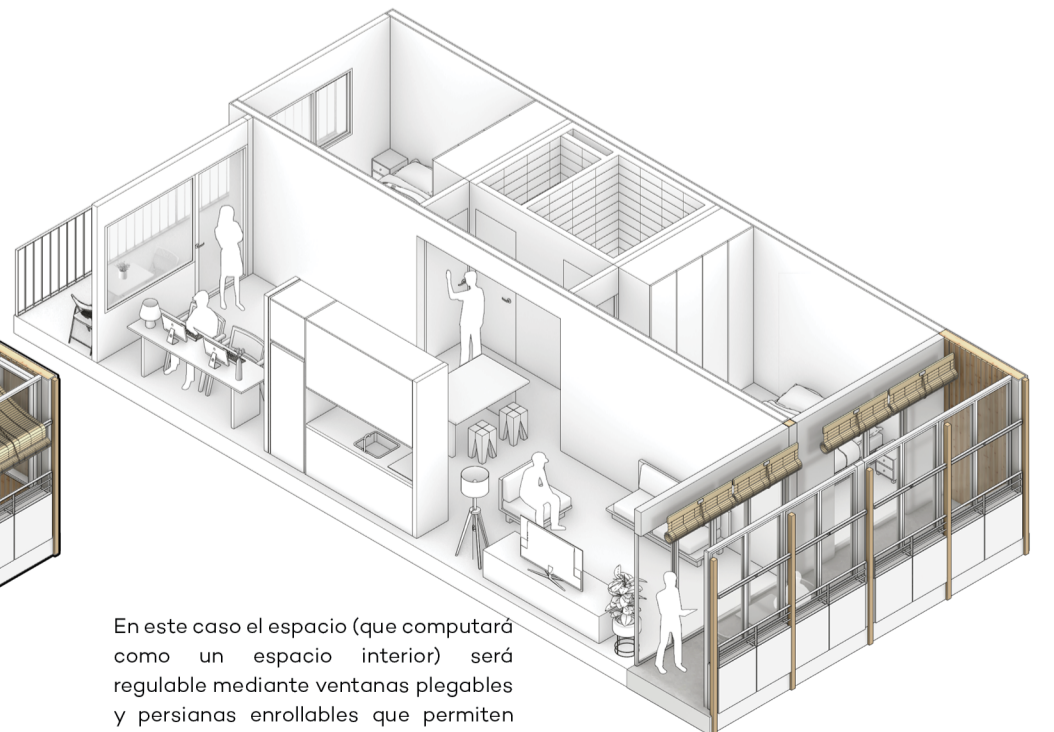
Invierno: La galería actúa como un invernadero precalentando pasivamente el aire, actuando la masa del suelo y paredes como acumulador.
