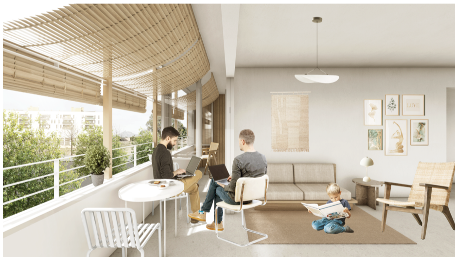
Verano: La galería actúa de umbráculo accionable creando una ventilación cruzada con la fachada perpendicular.
