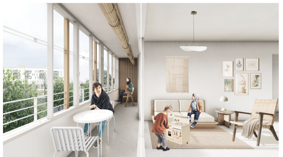
Invierno: La galería actúa como un invernadero precalentando pasivamente el aire, actuando la masa del suelo y paredes como acumulador.
