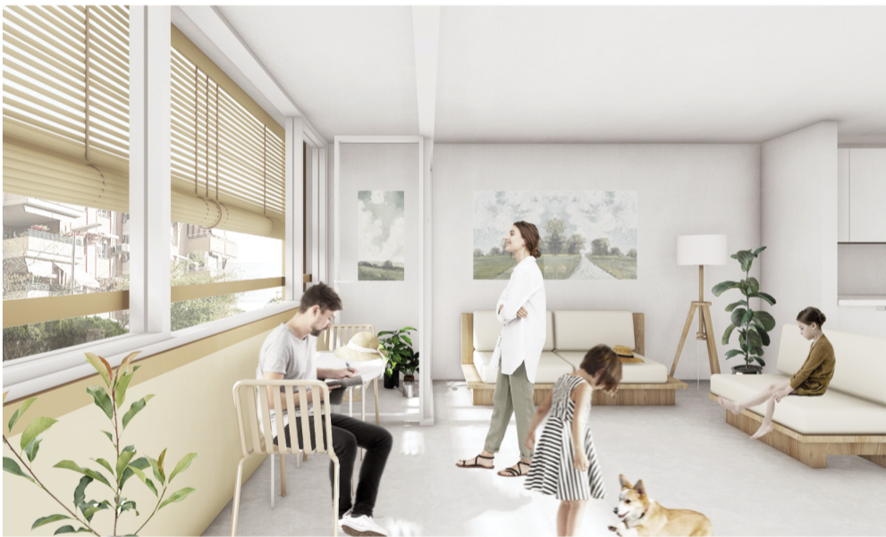
Verano: La galería actúa de umbráculo accionable creando una ventilación cruzada con la fachada perpendicular.
