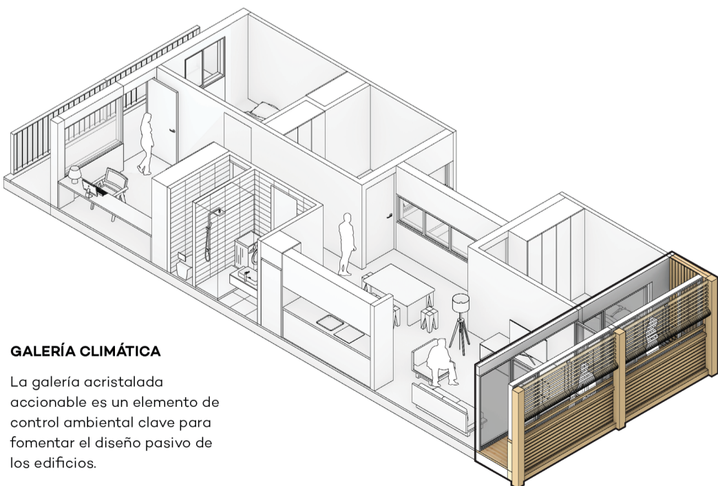
Verano: La galería actúa de umbráculo accionable creando una ventilación cruzada con la fachada perpendicular.
