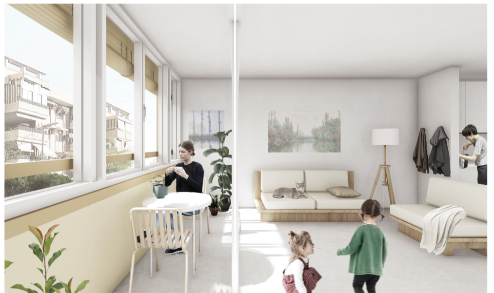
Invierno: La galería actúa como un invernadero precalentando pasivamente el aire, actuando la masa del suelo y paredes como acumulador.
